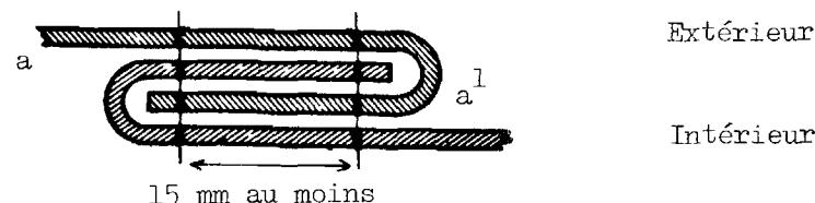
\*/ Les fils visibles de l'intérieur devront être de couleur différente de celle des fils visibles de l'extérieur et de celle de la bâche.
