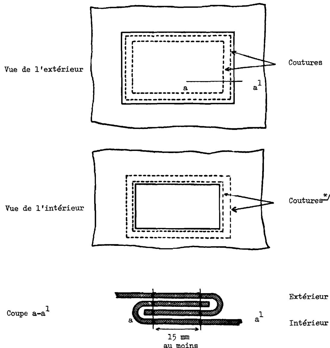
\*/ Les fils visibles de l'intérieur devront être de couleur différente de celle des fils visibles de l'extérieur, et de celle de la bâche.
